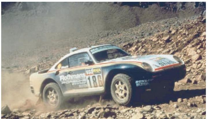
zata con una **gabbia d'acciaio saldata**. Le porte, il tetto, i parafanghi anteriori e tutti i finestrini, tranne il parabrezza, sono stati realizzati in policarbonato (plastica) per **risparmiare peso**. Poiché nella Parigi-Dakar si devono percorrere ogni giorno distanze enormi, gli ingegneri Porsche hanno anche installato un serbatoio da 120 litri nel bagagliaio anteriore e un ulteriore serbatoio da 150 litri dietro il sedile del conducente. I veterani francesi dei rally, René Metge e il
